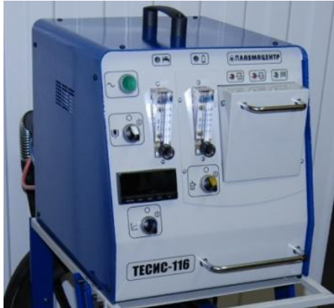
Рис. 1. Установка для клинического нанесения покрытия Pateks на имплантационные системы с одновременной их плазменной стерилизацией
