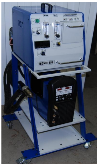
Рис. 7. Установка ТЕСИС-116 для нанесения биосовместимых и фреттингостойких покрытий
