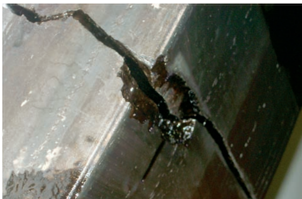
Усталостное растрескивание бандажа клинкерной печи, толщина – 250 мм
