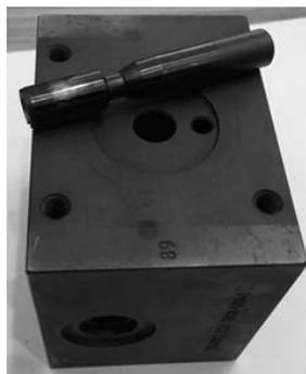
Рис. 1. Блок управления ТНВД (№ 23540850) двигателей MTU 16V4000 (MTU Friedrichshafen GmbH, Германия)
