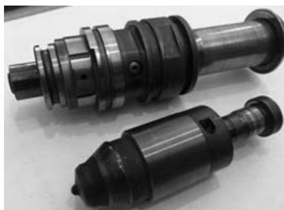
Рис. 2. Форсунка (№ 4088427) двигателей Cummins QSK45 (Cummins Inc., США)
