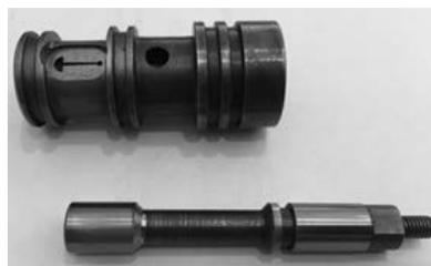
Рис. 3. Плунжерная пара (баррель и плунжер) подачи топлива ТНВД (№ 3077526) двигателей Cummins KTA 50, КТТА 38 (Cummins Inc., США)
