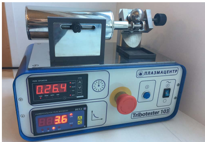
Рис. 3. Общий вид прибора Tribotester 103PC
