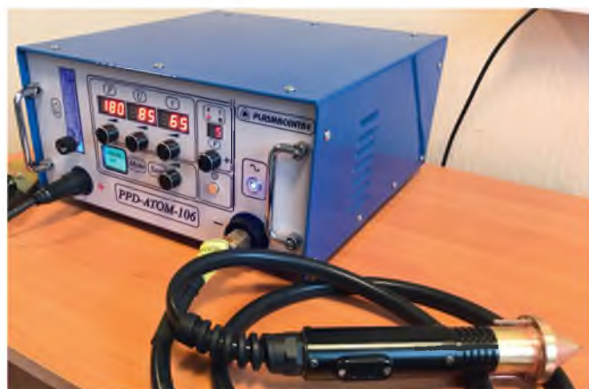
Рис. 10. Общий вид установки для ПИО покрытий модели PPD-ATOM-106
