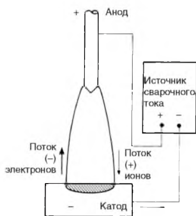
Рис. 3. Схема соединений при импульсной аргодуговой сварке на обратной полярности неплавящимся электродом
