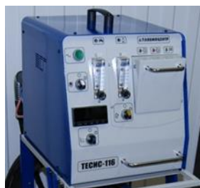
Рис. 1. Установка для клинического нанесения покрытий на имплантационные системы с одновременной их плазменной стерилизацией
