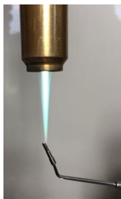
Рис. 2. Процесс нанесения биосовместимого покрытия с плазменной стерилизацией: вертикального винта для абатмента имплантата на оборудовании ООО «Плазмацентр»[7]
