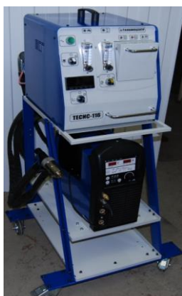
Рис. 8. Установка ТЕСИС-116 для нанесения биосовместимых и фреттингостойких покрытий
