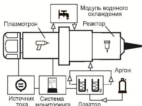
Рис. 1. Процесс ФПУ и общая схема оборудования
