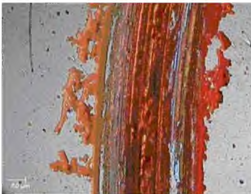
Рисунок 4 – Микрофотография дорожки износа, полученная на оптическом микроскопе AXIOVERT CA25 (Karl Zeiss, Германия), x 100
