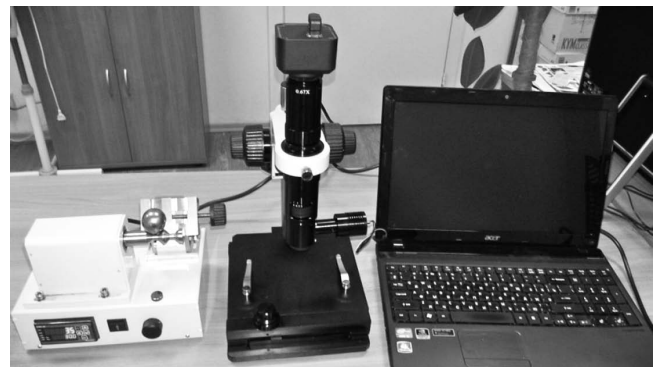
Рис. 5. Общий вид оборудования для испытаний на микроабразивное изнашивание
