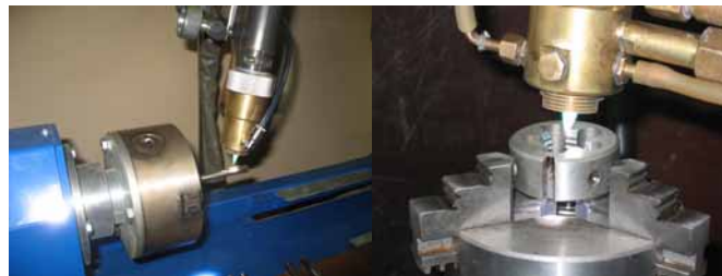
Рис. 1. Процесс финишного плазменного упрочнения резьбонарезного инструмента.
