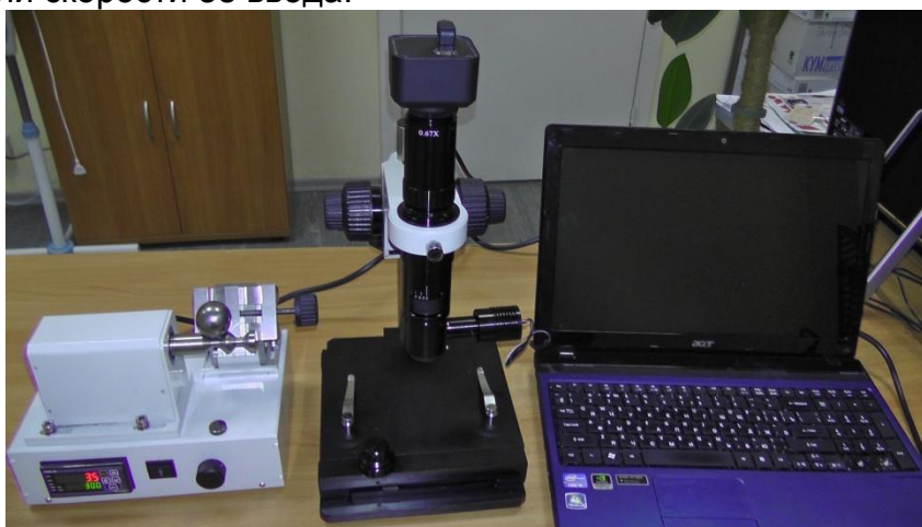
Рис. 1. Общий вид комплекта оборудования Tribotester PC102 для измерения толщины покрытия при испытаниях на микроабразивное изнашивание
