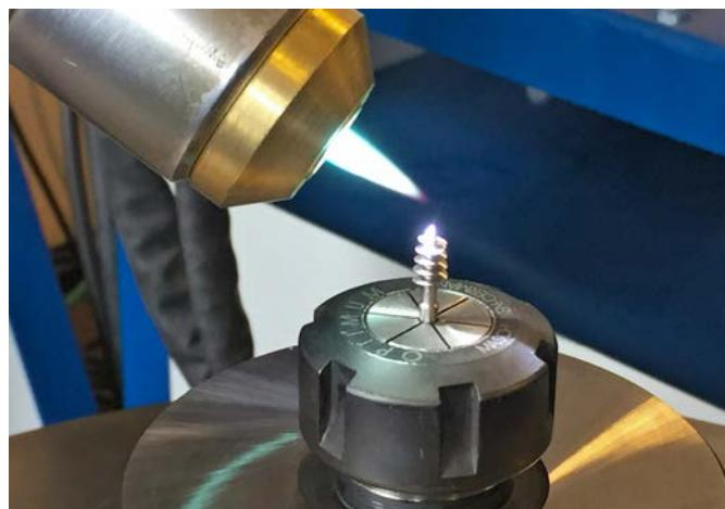
Рис. 1. Нанесение на дентальный имплантат покрытия Pateks
