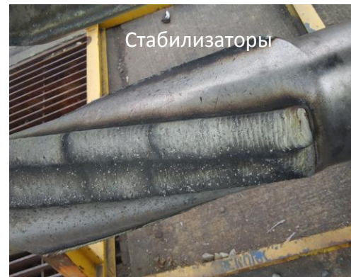
Корпус стабилизатора забойного двигателя
