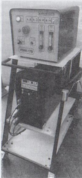
Рис. 1. Установка для микроплазменного напыления УПНН-170
