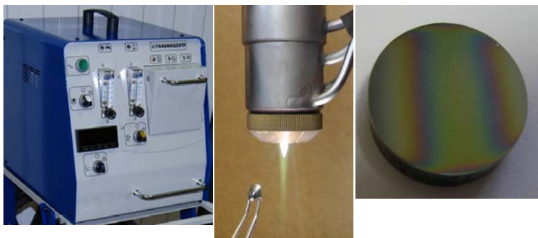
Рисунок 1. Установка для нанесения тонкопленочных кремнийсодержащих покрытий TesisDent-18 (а), процесс индивидуального нанесения покрытия PateksDent на коронку из стали 12X18H10T (б) и вид полосы покрытия на образце-свидетеле (в)
