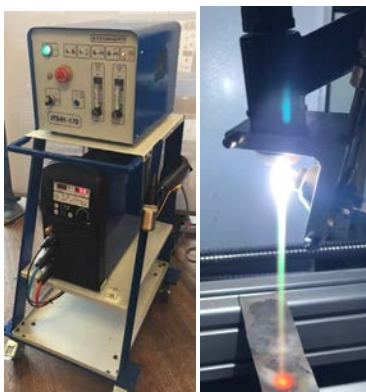
Рисунок 1. Установка для МПН УПНН-170 и вид плазменной струи в режиме МПН
