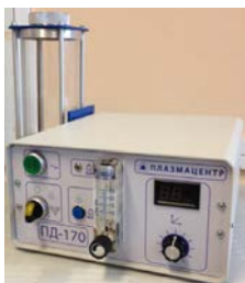
Рисунок 2. Порошковый дозатор ПД-170
