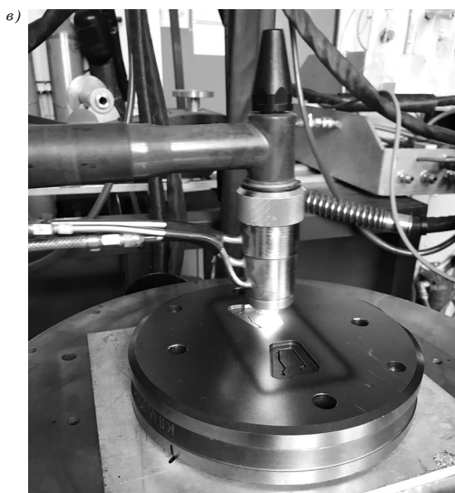
Рис. 8. Финишное плазменное упрочнение: а — гибкого вырубного ножа; б — дискового ножа; в — экструзионной фильеры; з — статора роторно-поршневого двигателя
