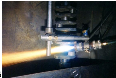
Рис. 11. Воздушно-плазменное напыление эрозионноустойчивых покрытий на вентиляционные лопатки турбогенераторов (а), восстановление коленчатого вала (б)
