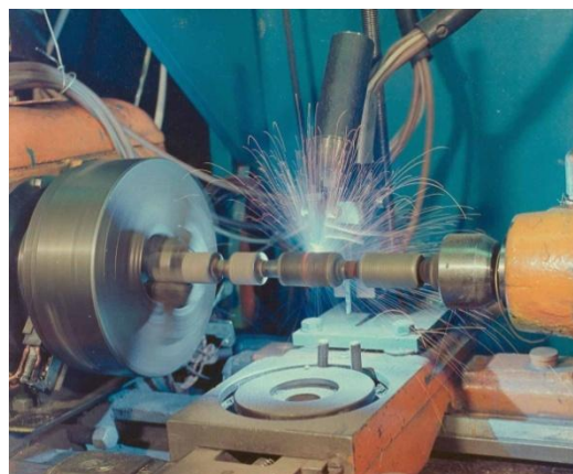
Рис. 15. Процесс скоростной плазменной наплавки золотника
