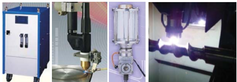
Рис. 9. Комплексное оборудование (блок аппаратуры, плазмотрон, порошковый дозатор) для плазменной наплавки-напыления и процесс нанесения покрытия на шнек.
