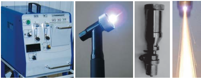
Рис. 10. Комплекс основного оборудования для микроплазменного напыления и вид плазменной струи.
