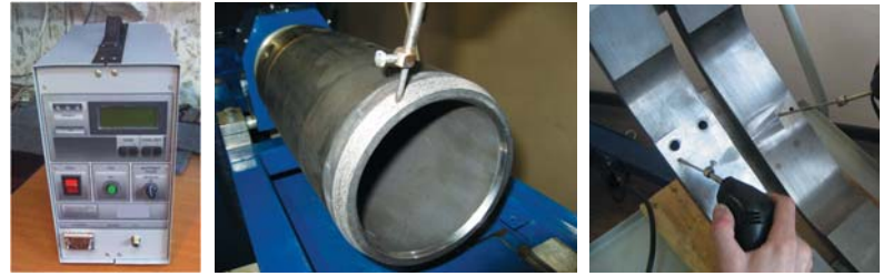
Рис. 5. Установка для плазменно-искрового нанесения покрытий (а), нанесение износостойкого покрытия из сплава ВК8 (б), нанесение электропроводящего серебряного покрытия (в).
