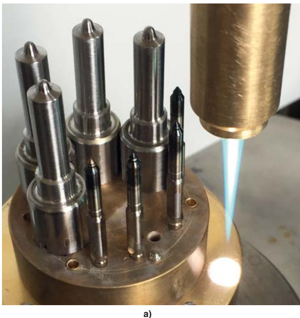
Рис. 10. Процесс нанесения покрытия DLCPateks на иглы распылителя и клапан форсунки фирмы Bosch (а), на детали ТНВД фирм L'Orange GmbH и Cummins Inc. (б)
