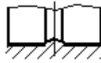
Рисунок 2 — Места износа опорно-поворотного круга на поверхности ролика – в виде кольцевой канавки, а на беговой дорожке – в виде кольцевого выступа
