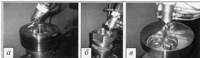
*Рис. 7. Практические примеры финишного плазменного упрочнения с нанесением алмазоподобного покрытия на рабочие поверхности вытяжной матрицы (а), вставки литьевой формы (б) и матрицы пресс-формы (в)*
