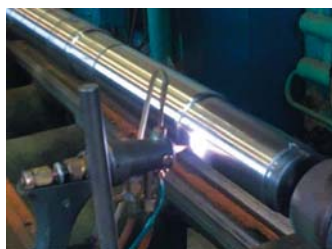
Рис. 4. Процесс нанесения нанопокрывания MultiPateks на посадочные поверхности вала.
