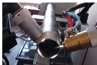
Рис. 2. Процесс нанесения трибологического нанопокрытия TriboPateks на резьбовую часть НКТ.
