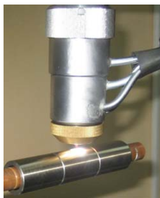
Рис. 3. Процесс нанесения алмазоподобного нанопокрывания DLCPateks на наружные поверхности втулок подшипников скольжения УЭЦН.
