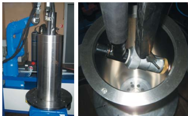
Рис. 5. Процесс нанесения нанопокрывтия SuperPateks на цилиндрическую втулку бурового насоса.
