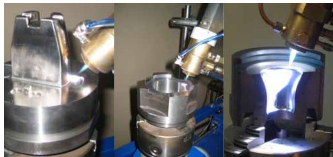
Рис. 4. Процесс финишного плазменного упрочнения деталей пресс-форм литья под давлением алюминиевых и медных сплавов (а, б), стеклоформы (в).
