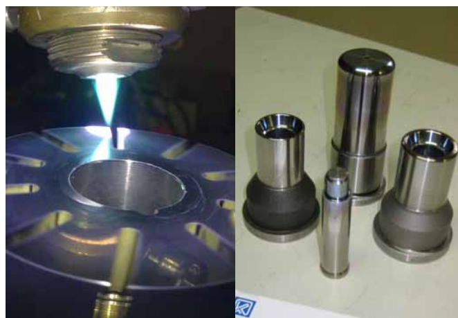
Рис. 5. Финишное плазменное упрочнение деталей гидравлических (а) и топливных агрегатов (б) с покрытием системы Si-O-C-N.
