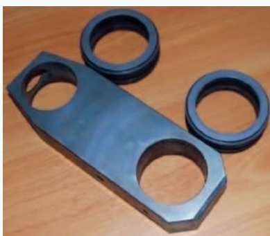
Рис. 9. Шибер и седло из стали 40X задвижки ЗМ 50x21 после ФПУ (ОАО «Завод Сибнефтегазмаш» (Тюмень))
