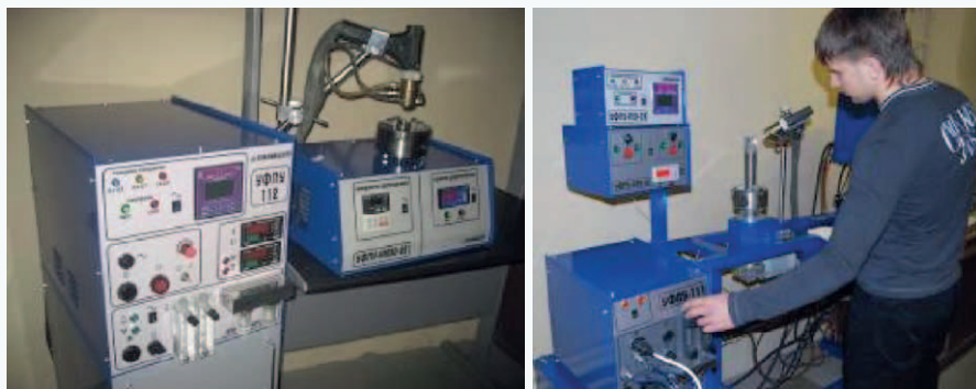
Рис. 10. Установки для ФПУ с нанесением нанопокрывания
