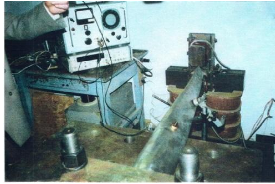
Рис. 8. Стендовые виброиспытания лопатки
