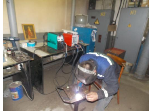
Рис. 6. Сварка двух частей лопатки
