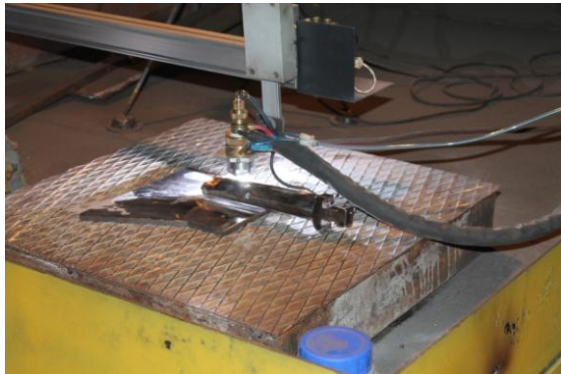
Рис. 7. Плазменная наплавка кромки лопатки
