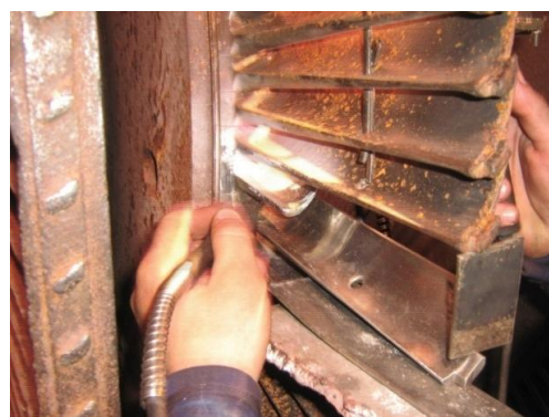
Рис. 2. Лопатки роторов паровых турбин с недостающими частями
