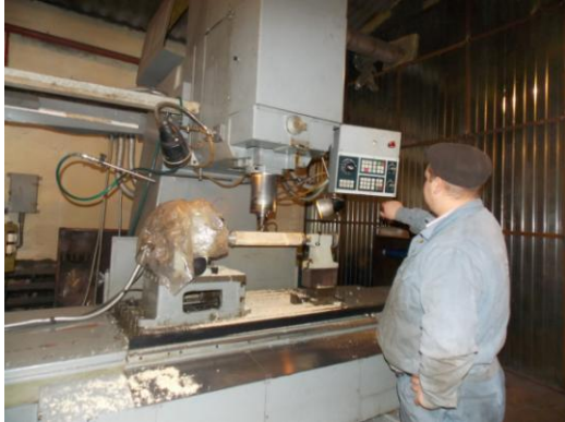
Рис. 5. Изготовление недостающего элемента лопатки паровой турбины на станке 2E450
