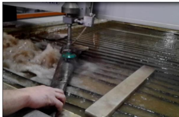
Рис. 4. Процесс гидроабразивной резки лопатки
