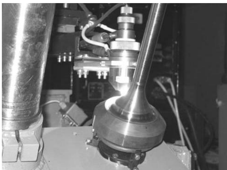
Рис. 8. Процесс автоматизированной плазменно-порошковой наплавки клапанов судовых дизелей
