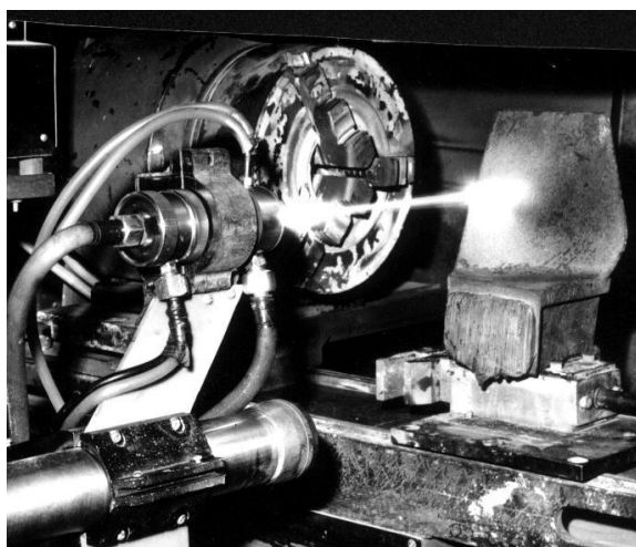
Рис. 3. Процесс напыления вентиляционной лопатки
