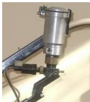
Рис. 6. Импульсный порошковый питатель
