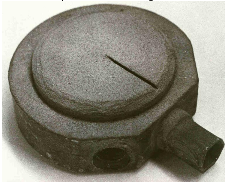
Рис. 1. Охладитель после напыления электроизоляционного покрытия из оксида алюминия
