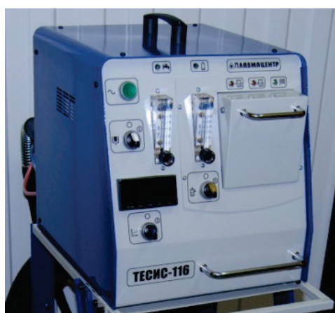
Рис. 1. Установка для клинического нанесения покрытия Pateks на имплантационные системы с одновременной их плазменной стерилизацией
