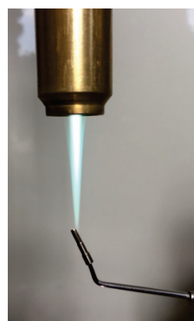
Рис. 2. Процесс нанесения биосовместимого покрытия Pateks с плазменной стерилизацией вертикального винта для абатмента имплантата
