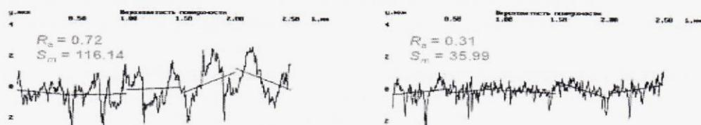
Рис. 5. Профилограммы поверхности, где а – до нанесения покрытия  $R_a=0,72$ ;  $R_{max}=5,07$ ;  $Sm=116,14$ ; б – после нанесения покрытия  $R_a=0,31$ ;  $R_{max}=3,47$ ;  $Sm=35,99$  (MarSurf M 300 (Mahr GmbH, Германия)
