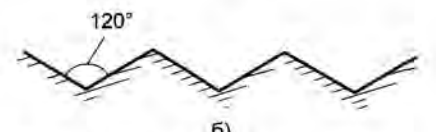
Рис. 4. Выступы поверхности с плоскими (а) и остроконечными площадками (б)
