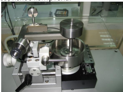
Рис. 1. Общий вид трибометра Tribometer (CSM, Швейцария) - (а) и вид протокола испытания на компьютере - (б)
