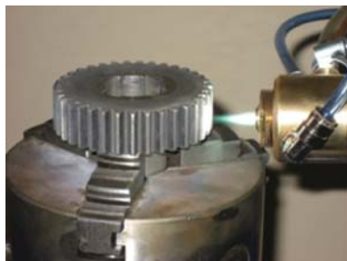
Рис. 4. Процесс нанесения покрытия методом ФПУ.
