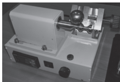
Рис. 2. Вид триботестера после установки шара.
