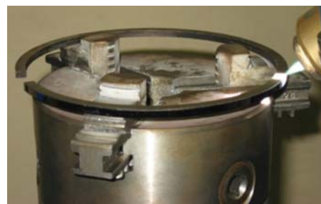
Рис. 1. Процесс нанесения антифрикционного покрытия методом ФПУ на поршневое кольцо
