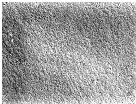
Рис. 3. Топография поверхности рабочей дорожки внутреннего кольца ПК (увеличение \times 5000 ): а/ до ФПУ; б/ после ФПУ
