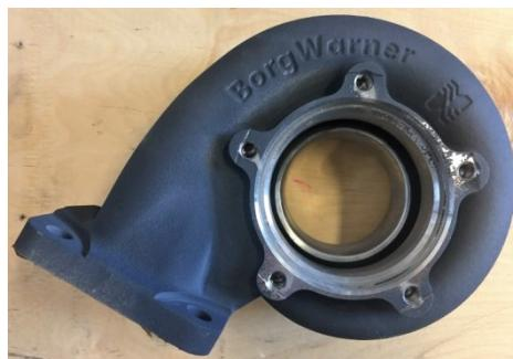
Рисунок 12 – Коллектор с покрытием  $\text{Al}_2\text{O}_3\text{-TiO}_2$
