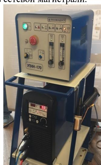
Рисунок 4 – Блок аппаратуры и источник тока установки для МПН
