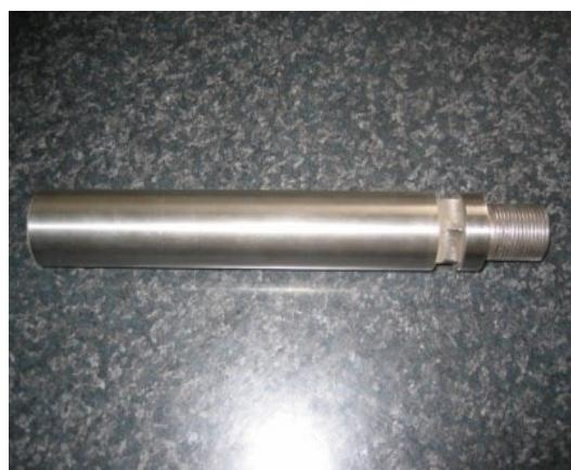
Рисунок 9 – Плунжер с покрытием WC-Co
