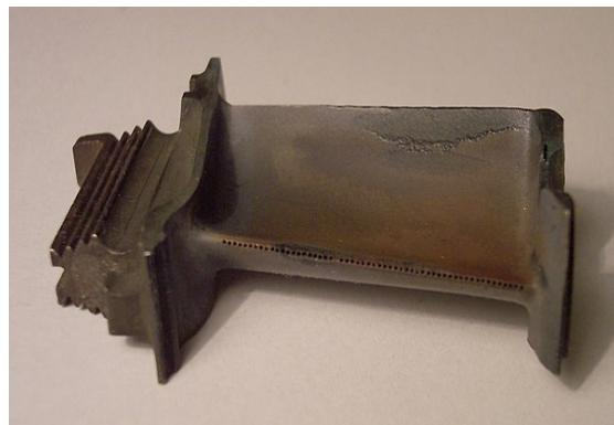
Рисунок 11 – Лопатка газотурбинного двигателя с покрытием Stellite 6 - керамические покрытия ( $\text{TiO}_2$ ,  $\text{Al}_2\text{O}_3$ ,  $\text{ZrO}_2$ ) [12];
