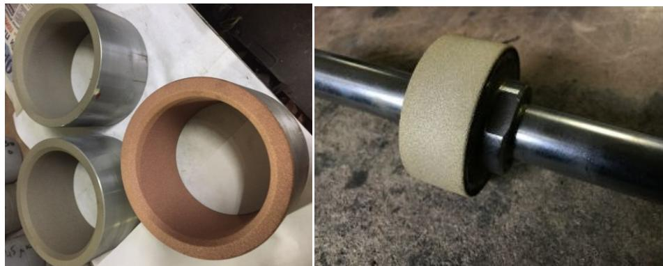
Рисунок 10 – Детали подшипников скольжения с покрытием из бронзы ПР-БрАЖНМц 8,5-4-5-1,5 и меди M1
