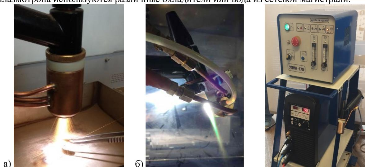
Рисунок 3 – Вид плазмотронов с аксиальным вводом порошка (а) и вынесенным анодом (б)
