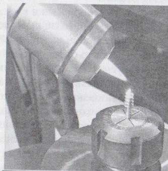
Рис. 2. Процесс нанесения биоактивного стеклокерамического нанопокрытия
