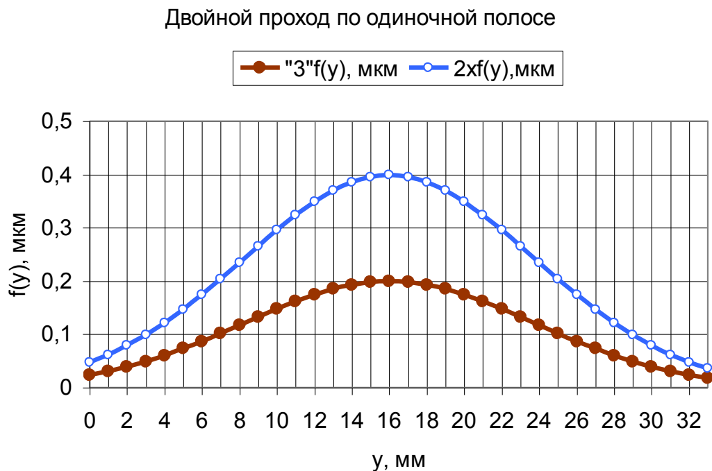
Рис. 5. Распределение толщины покрытия поперек одиночной полосы упрочнения при R_э = 11 мм для одного прохода и двух проходов
