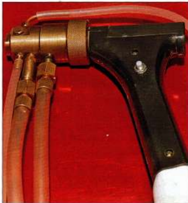
Фото 1. Плазмотрон с плазмохимическим генератором для ФПУ
