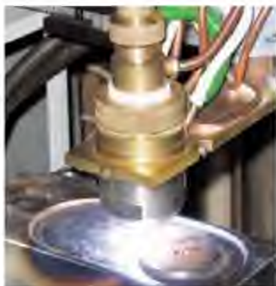
Рис. 2. Плазменная наплавка – напыление задвижки газовой арматуры
