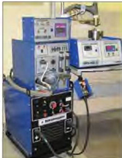
Рис. 1. Комплекс оборудования для финишного плазменного упрочнения с нанесением алмазоподобного покрытия
