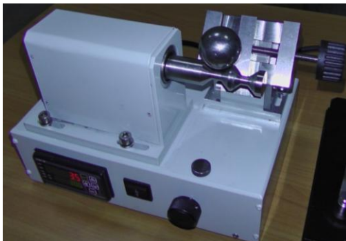
Рис. 2. Вид триботестера после установки шара
