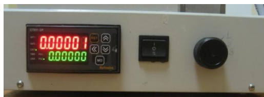
Рис. 4. Вид счетчика-таймера на передней панели триботестера Tribotester PC102
