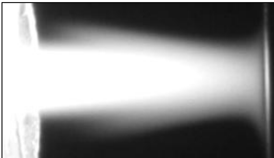
Рис. 3. Плазменная струя при нанесении тонкопленочного упрочняющего покрытия (дистанция обработки 15 мм)
