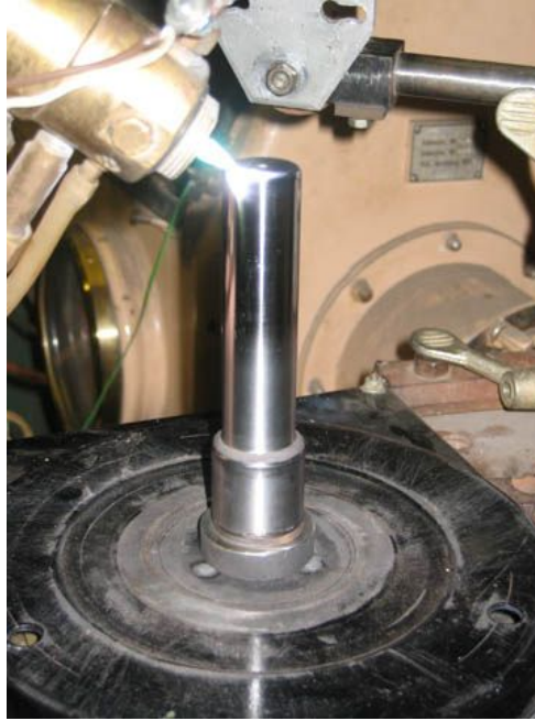
Рисунок 5 – Пример упрочнения ФПУ пуансона
