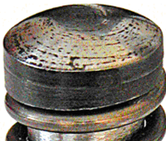
Рисунок 3 – Износ сферической поверхности верхнего вкладыша
