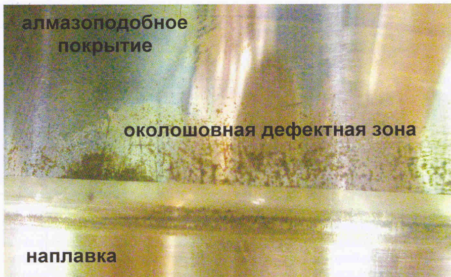
Рис. 6. Внешний вид плунжера с тремя переходными зонами: наплавки, околошовной зоной, алмазоподобного покрытия после испытания
