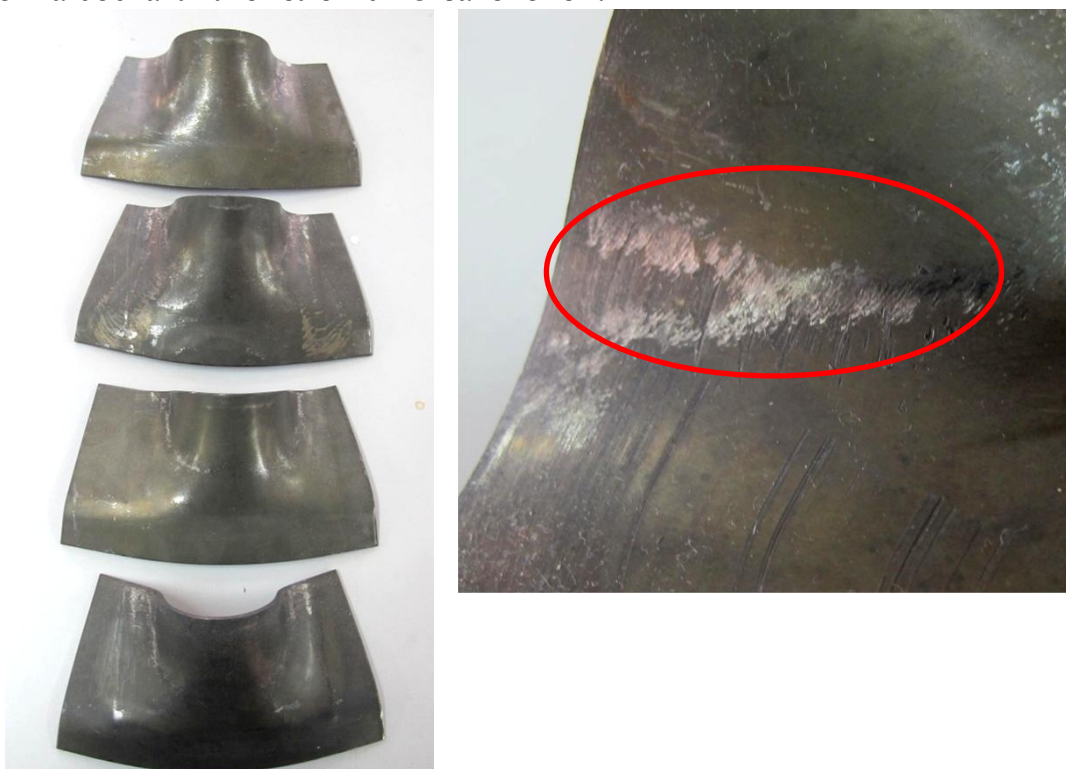
Рис. 1. Деталь 1460700157 «Лепесток смесителя» с дефектом в виде надиров после формовки на штампе без покрытия
