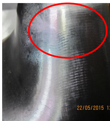
Рис. 5. Вид штампа с образовавшимися надирями после 120 штамповок
