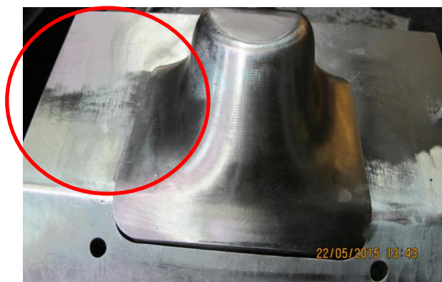
Рис. 5. Вид штампа с образовавшимися надирями после 120 штамповок
